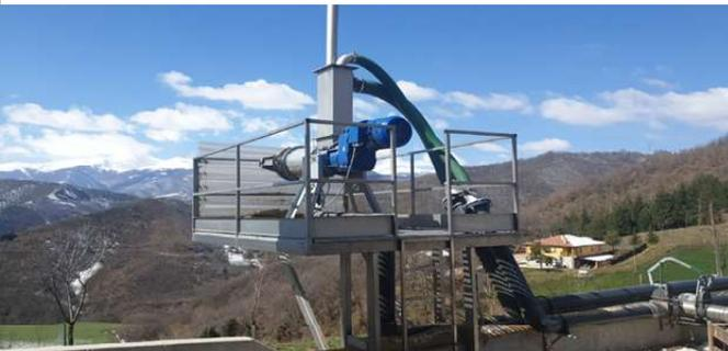
**FINO AL 40% DI SOSTANZA SECCA PRONTA ALL'USO. L'IMPORTANZA DI UN IMPIANTO DI SEPARAZIONE BEDDING E I SUOI VANTAGGI:** Consente di estrarre dai propri reflui zootecnici una sostanza solida separata che può arrivare fino al 40%, che può essere riutilizzata immediatamente in cuccetta o lettiera permanente.
